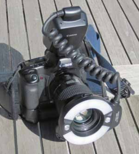
Abb. 6: Ringblitz Röhre B oben A unten und EF 100 an der EOS 5D.
