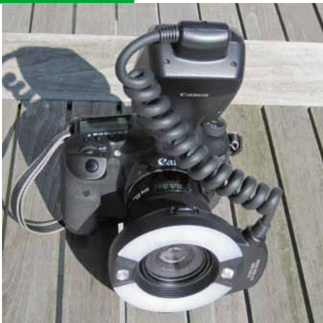
Abb. 4: Ringblitz Röhre B oben A unten und EF-S 60 an der EOS 7D.
